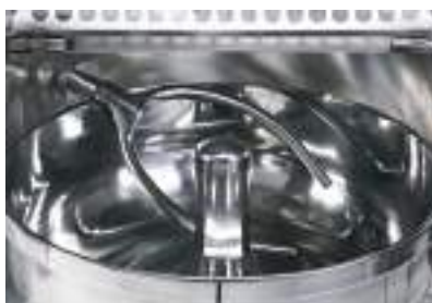
Cuve, fourche et couvercle en acier inox AISI 304
