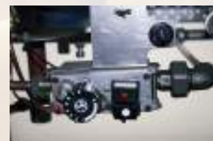
Allumage par piezzo installé dans la zone froide pour protéger les composants de la chaleur - Réglage de la T° via le bloc minisit
