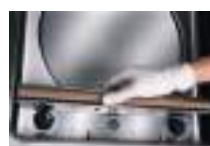
Barre de soudure extractible sans cables sur série SATURNO
